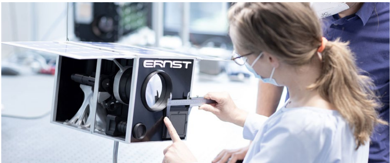
Der Kleinsatellit ERNST, entwickelt vom Fraunhofer-Institut für Kurzzeitdynamik, Ernst-Mach-Institut, der u. a. für die Detektion von Raketenstarts eingesetzt werden könnte
