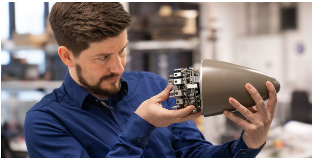
Florian Hilpert, Geschäftsfeldentwickler Leistungselektronische Systeme am Fraunhofer IISB, bei der Inspektion eines hocheffizienten 15 kW Luftfahrtumrichters
